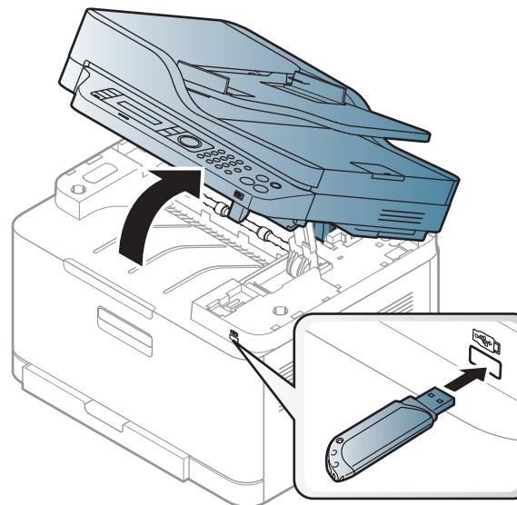
本机前面的 USB 存储器端口专门用于 USB V1.1 和 USB V2.0 存储器设备。本机支持 FAT16/FAT32 且扇区大小为 512 字节的 USB 内存设备。
