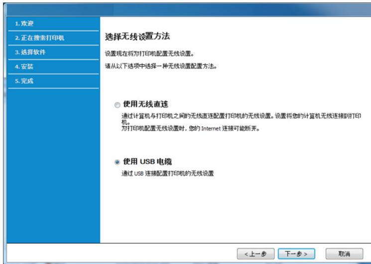
8 搜索后，窗口中会显示无线网络设备。选择要使用的接入点名称 (SSID)，然后单击下一步。
