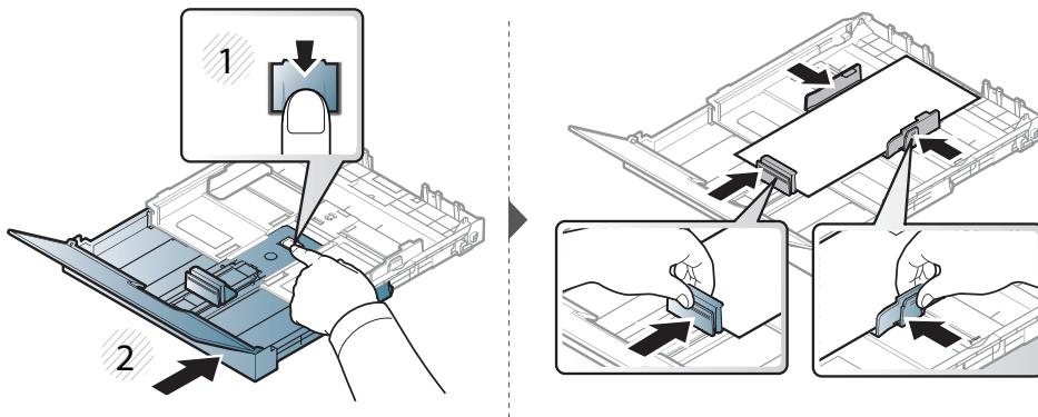
如果纸张尺寸比 Legal 长, 请按下纸盘中的导板锁将其松开, 手动拉出纸盘。然后调整纸张长度导板和纸张宽度导板。
